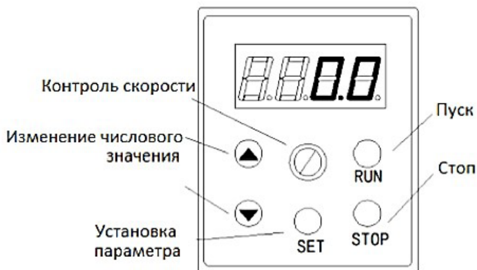
Рис. 3. Функциональные клавиши на панели управления преобразователем частоты
